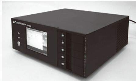
高速信号処理装置「FSP2000」。従来の4倍、4Gbpsのサンプリング能力を持つ
